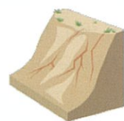
がけに 割れ目 、 ひび割れが入る
